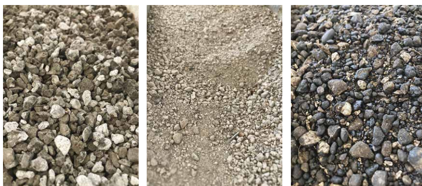
3A, 3B e 3C. Gli aggregati utilizzati: granella di scoria da acciaieria (3A), sabbia da RSU (3B), granulato di conglomerato bituminoso (3C)
