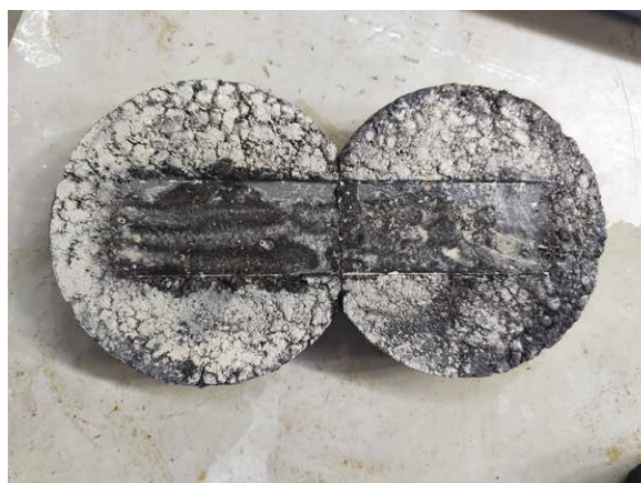
6. I provini alla fine del test Hamburg Wheel Track
